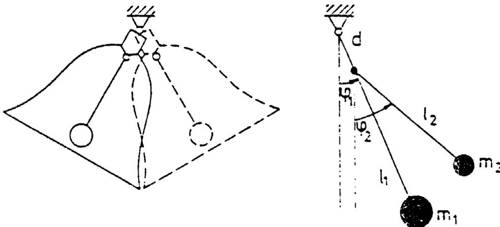
Für die Ausschläge von Glocke (Index 1) und Klöppel (Index 2), siehe Abb.5, erhält man mit den reduzierten Pendellängen  $l_i$ , den Massen  $m_i$  und dem Abstand  $d$  die Bewegungsgleichungen
